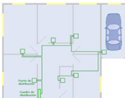
3.- Conexionado en bus continuo
